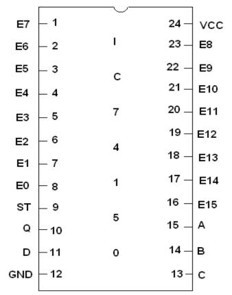
PIN DIAGRAM FOR IC 74154:
