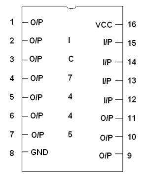
**PIN DIAGRAM FOR IC 74147:**
